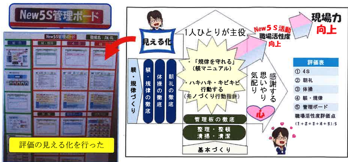
図 3.1 New 5 S 活動による現場力向上へのステップ
